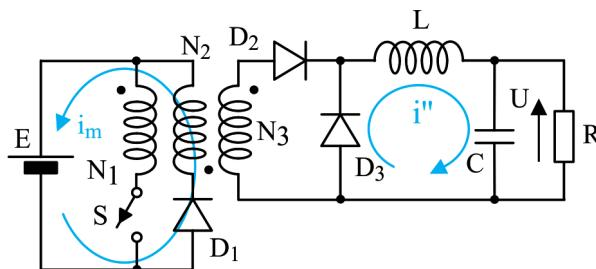
Slika 3.23. Direktni čoper sa galvanskom izolacijom – interval  $t_{OFF}$ .
