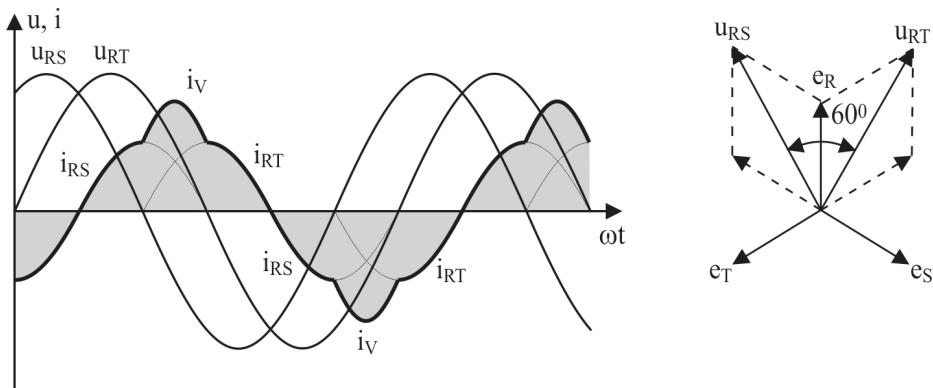
**Sl. 1.14. Struja u priključnom vodu trofaznog kompenzatora.**
