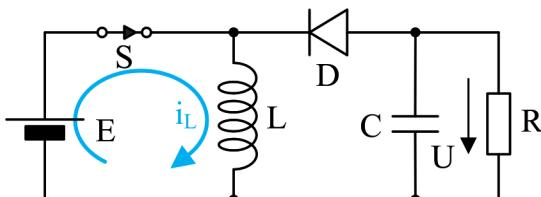
Slika 3.49. Čoper spuštač i podizač napona – interval  $t_{ON}$ .
