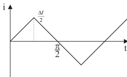
Slika 3.17. Vremenski dijagram naizmenične komponente struje prigušnice.
