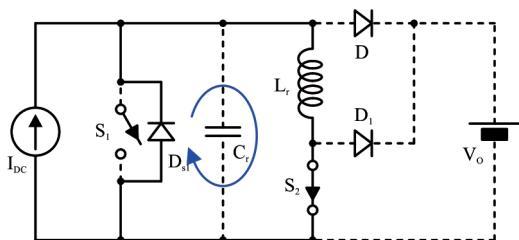
*Slika 3.44. Uključenje antiparalelnе diode  $D_{S1}$ .*
