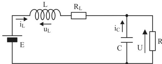
Slika 3.33. Ekvivalentna šema čopera – interval  $t_{OFF}$ .
