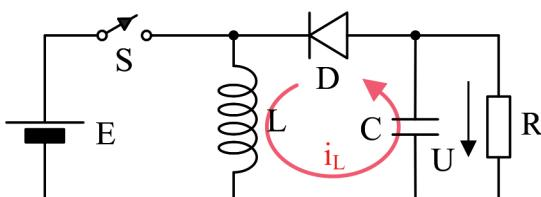
Slika 3.50. Čoper spuštač i podizač napona – interval  $t_{OFF}$ .
