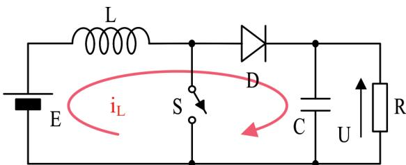
Slika 3.30. Čoper podizač napona – interval  $t_{OFF}$ .
