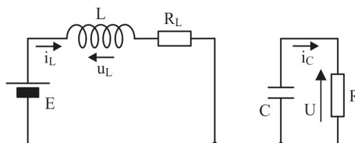
Slika 3.32. Ekvivalentna šema čopera – interval  $t_{ON}$ .
