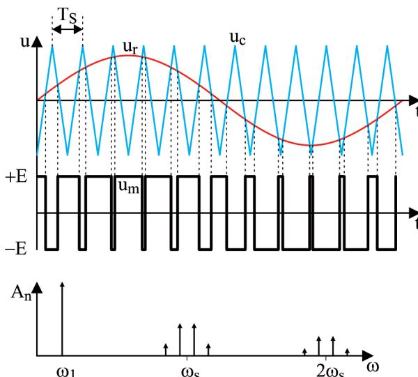
*Slika 4.3. Modulacija trajanja impulsa monofaznog polemosnog naponskog invertora.*
