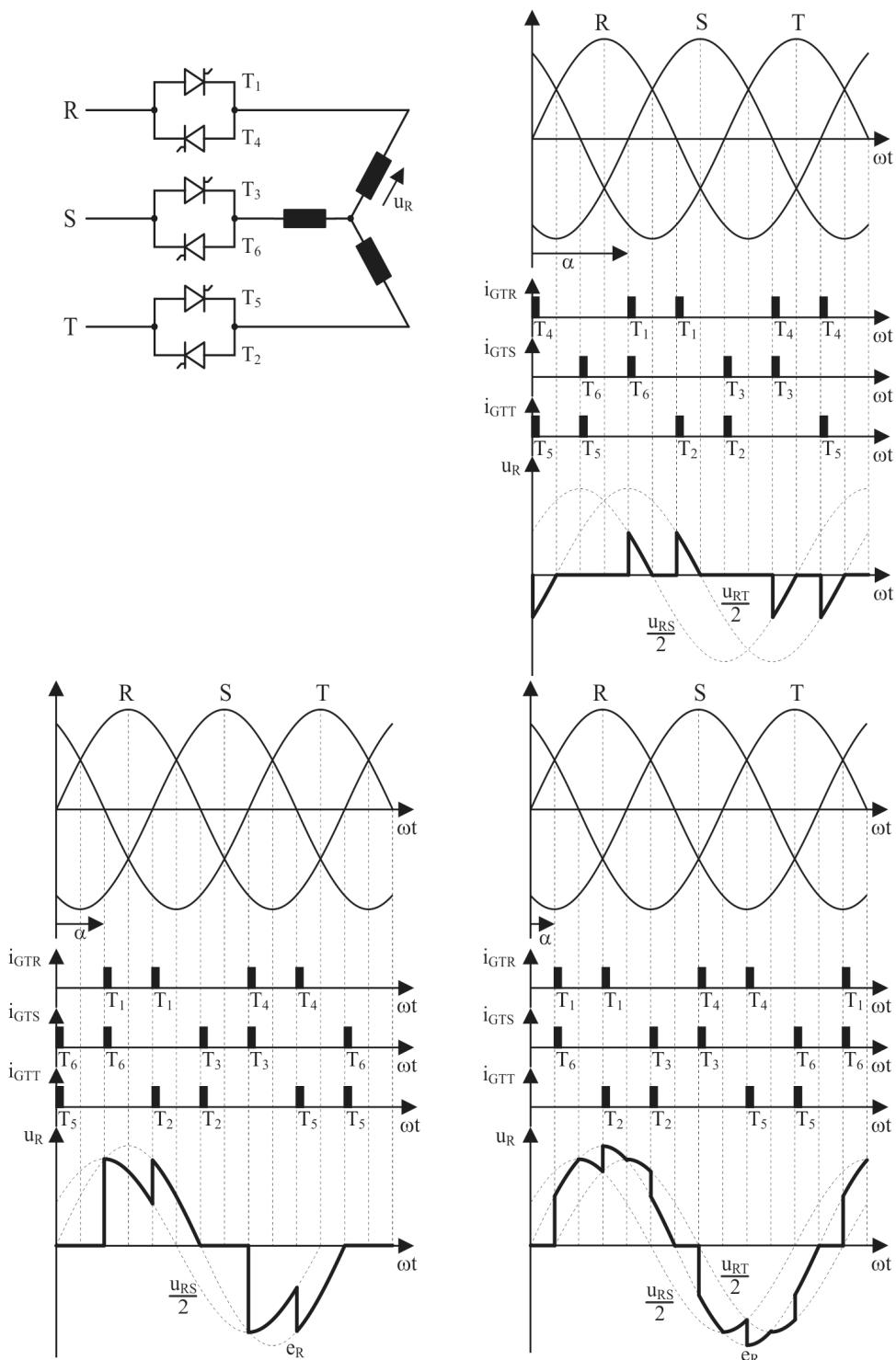
Sl. 1.11. Talasni oblici napona na opterećenju za  $\alpha = 120^\circ$ ,  $\alpha = 60^\circ$  i  $\alpha = 30^\circ$
