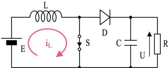
Slika 3.29. Čoper podizač napona – interval  $t_{ON}$ .
