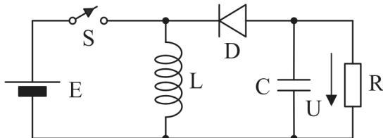
Slika 3.48. Čoper spuštač i podizač napona.
