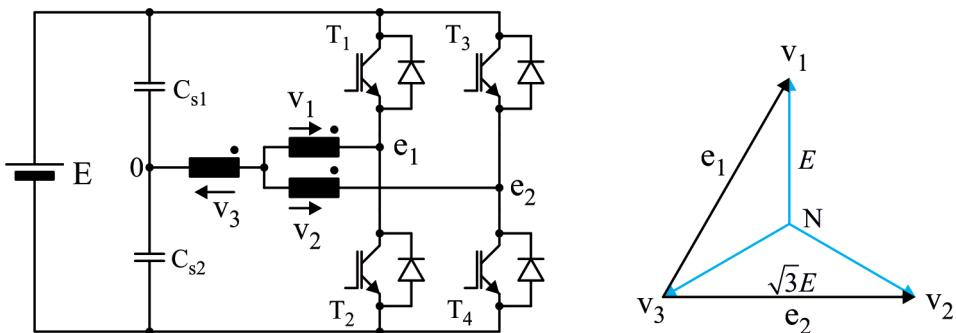
*Slika 4.10. Napajanje trofaznog opterećenja iz dva polumosna invertora.*
