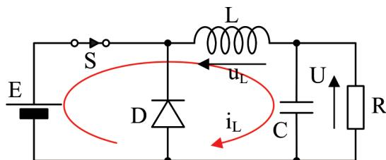
*Slika 3.11. Čoper spuštač napona – interval  $t_{ON}$ .*
