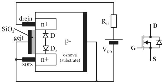
*Slika 3.3. Uprošćena struktura i simbol N-kanalnog MOSFET-a.*
