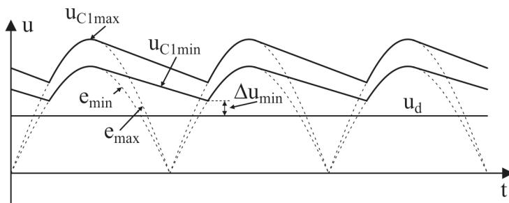
*Slika 3.2. Napon na ulazu linearogn regulatora.*
