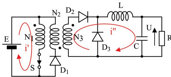
Slika 3.22. Direktni čoper sa galvanskom izolacijom – interval  $t_{ON}$ .
