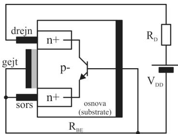
*Slika 3.6. Parazitni NPN tranzistor u strukturi MOSFET-a.*
