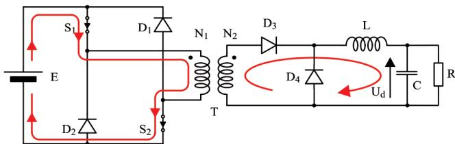
Slika 3.26. Asimetrični mosni pretvarač – interval  $t_{ON}$ .
