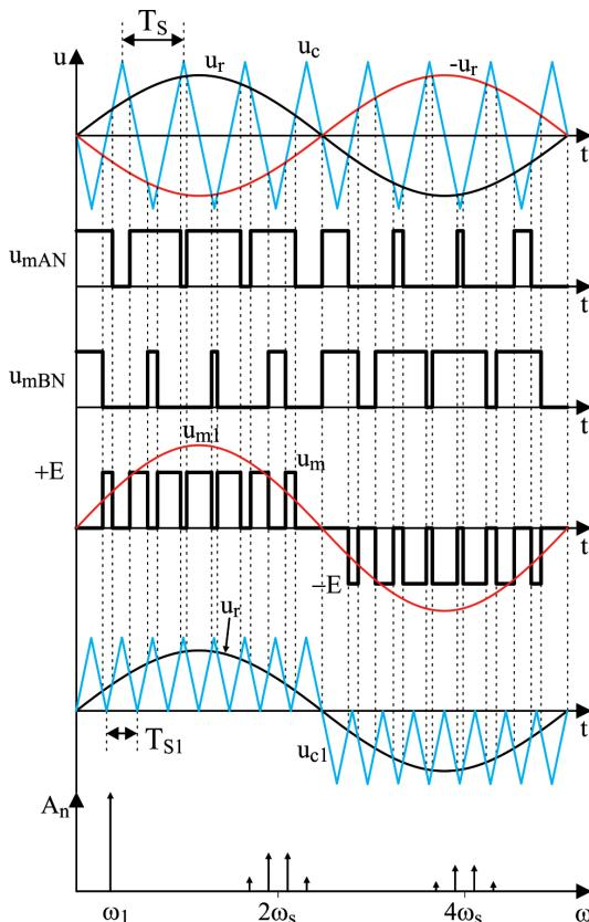
*Slika 4.5. Modulacija trajanja impulsa monofaznog mosnog naponskog invertora.*
