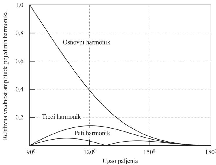
**Sl. 1.13. Relativne vrednosti amplitude harmonika u strujama kod monofaznog faznog regulatora sa induktivnim opterećenjem.**
