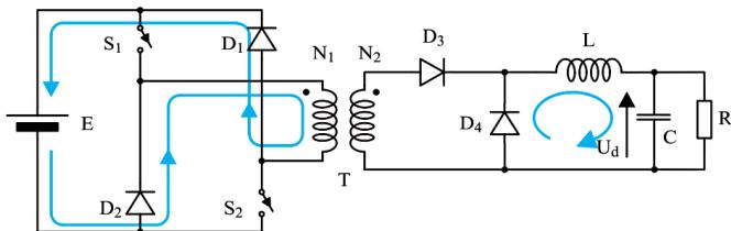
Slika 3.27. Asimetrični mosni pretvarač – interval  $t_{OFF}$ .
