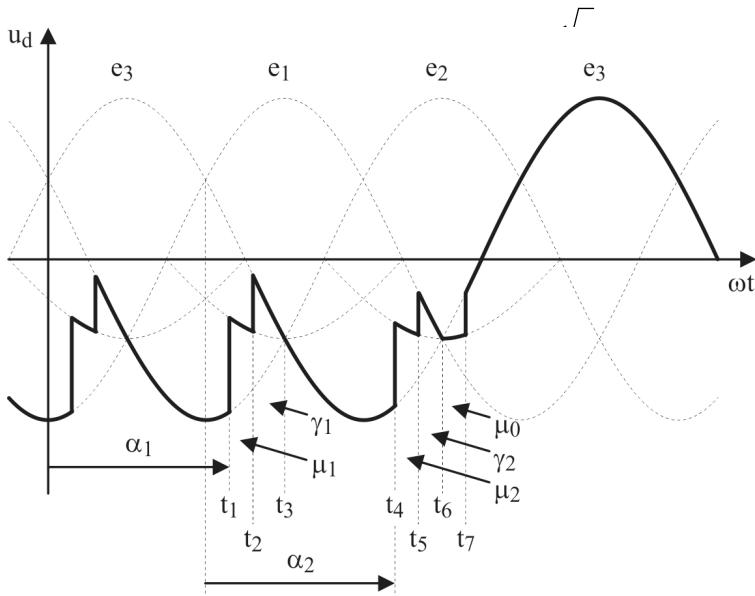
*Sl. 2.18. Tresnačinska karakteristika napona na opterećenju pri neuspešnoj komutaciji u invertorskom režimu rada.*
